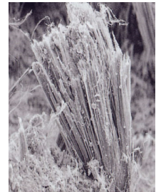
Aufnahme von Asbestfasern unter dem Rasterelektronenmikroskop
